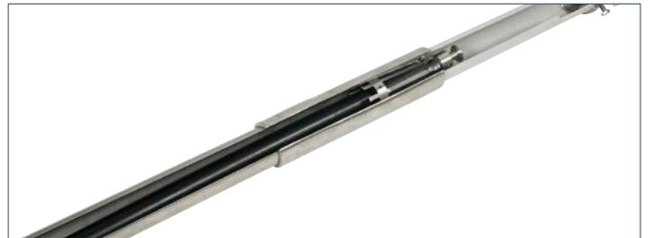
**Schritt 2:** Das Kopfstück für die Innenverlegung der HVI®power-Leitung wird seitlich mit einer Arretierungs-Schraube fixiert. Die Position der Schraube zeigt, ob die Montage korrekt durchgeführt wurde.
