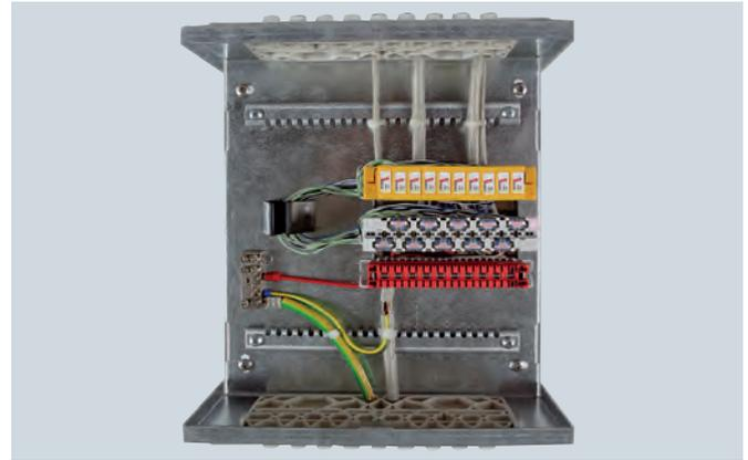
DPG sind verschließbare Metallgehäuse und vorbereitet zum Einbau von Verdrahtungs- und Schutzkomponenten. In vier unterschiedlichen Größen beinhalten die blitzstromtragfähigen Gehäuse zudem Klemmmöglichkeiten für das Einbeziehen von Überspannungs-Ableitern und Schirmen in den Potentialausgleich.
