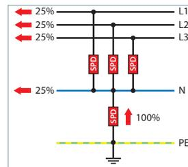
3+1-Schaltung mit einem höheren Ableitvermögen  $4 \times 20 \text{ kA} = 80 \text{ kA}$ .
