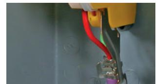
EMV-Federklemme als Zubehör für dauerhafte, niederimpedante Schirmkontaktierung.
