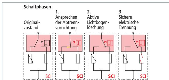
Dreistufige DC-Schalteinrichtung (patentiertes SCI-Prinzip)
