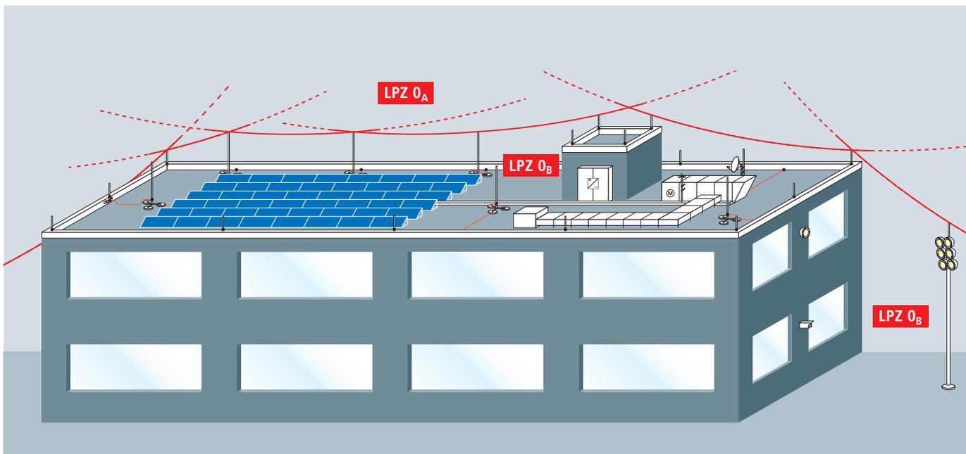
▲ Bild 5.1: Übergang LPZ 0<sub>A</sub> – LPZ 0<sub>B</sub> (oben)
