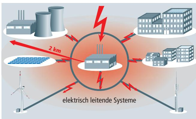
**Bild 2:** Prinzipielle Gefährdung von Gebäuden und Anlagen durch Blitzereinschlag.
