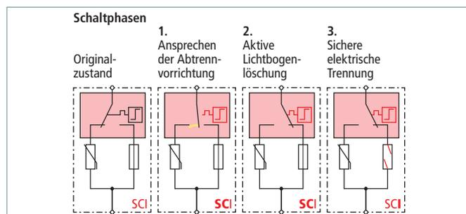
Dreistufige DC-Schalteinrichtung (patentiertes SCI-Prinzip)
