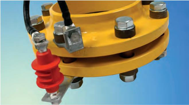
ATEX und IECEx-zertifizierte Trennfunknestrecke für den Blitzschutz-Potentialausgleich nach DIN EN 62305 / VDE 0185 mit tiefer Ansprechspannung.
