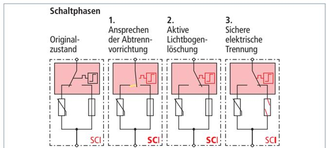
Dreistufige DC-Schalteinrichtung (patentiertes SCI-Prinzip)
