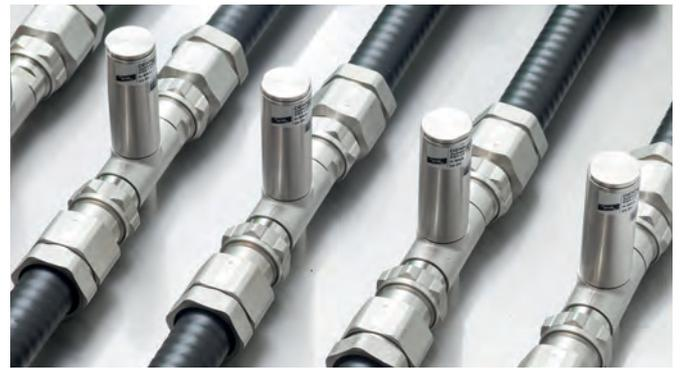
DEHNgate ist eine Familie aus Blitzstrom- / Überspannungs-Ableitern in Kabeladapter-Bauform für koaxiale Systeme wie Mobilfunk- und Antennenanlagen. Je nach Anwendung stehen verschiedene mechanische und elektrische Gerätevarianten zur Verfügung. Die unterschiedlichen Bauformen und Ableiter-Technologien ermöglichen optimal abgestimmte Lösungen für ein breites Anwendungsspektrum.
