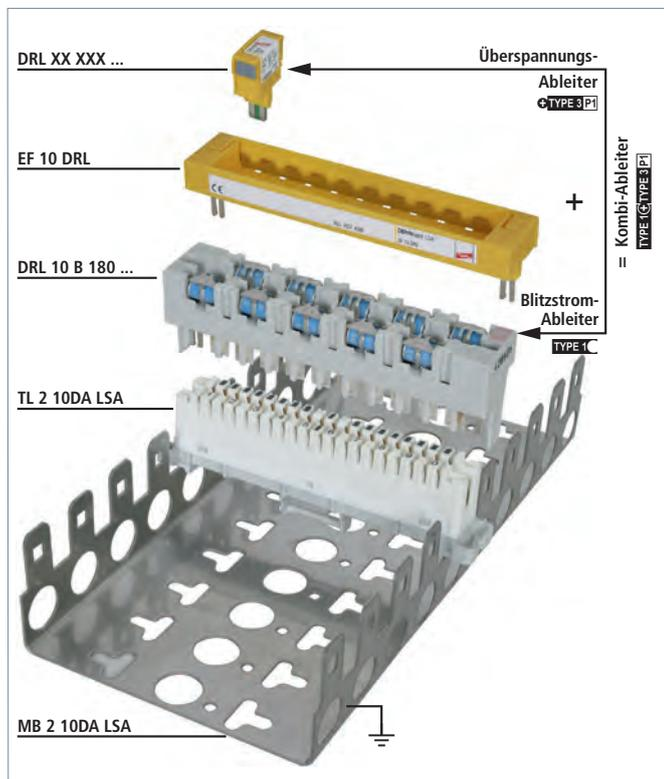
Modularer Aufbau bestehend aus Steckmagazin mit Gasentladungsableitern, Erdungsrahmen und anwendungsspezifischen Ableiter-Modulen.
