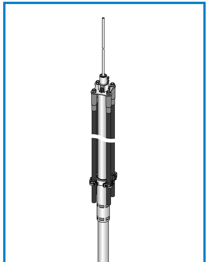
Bild 9 Montage Außenverlegung - Komplett
