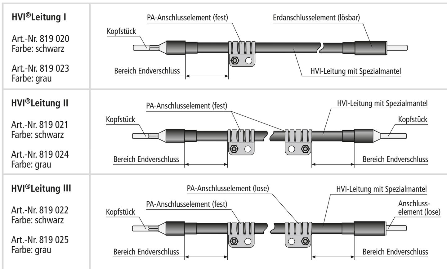
**Bild 1** Aufbau HVI®Leitung als konfektionierte Leitung, Kopfstück ist werksseitig montiert
