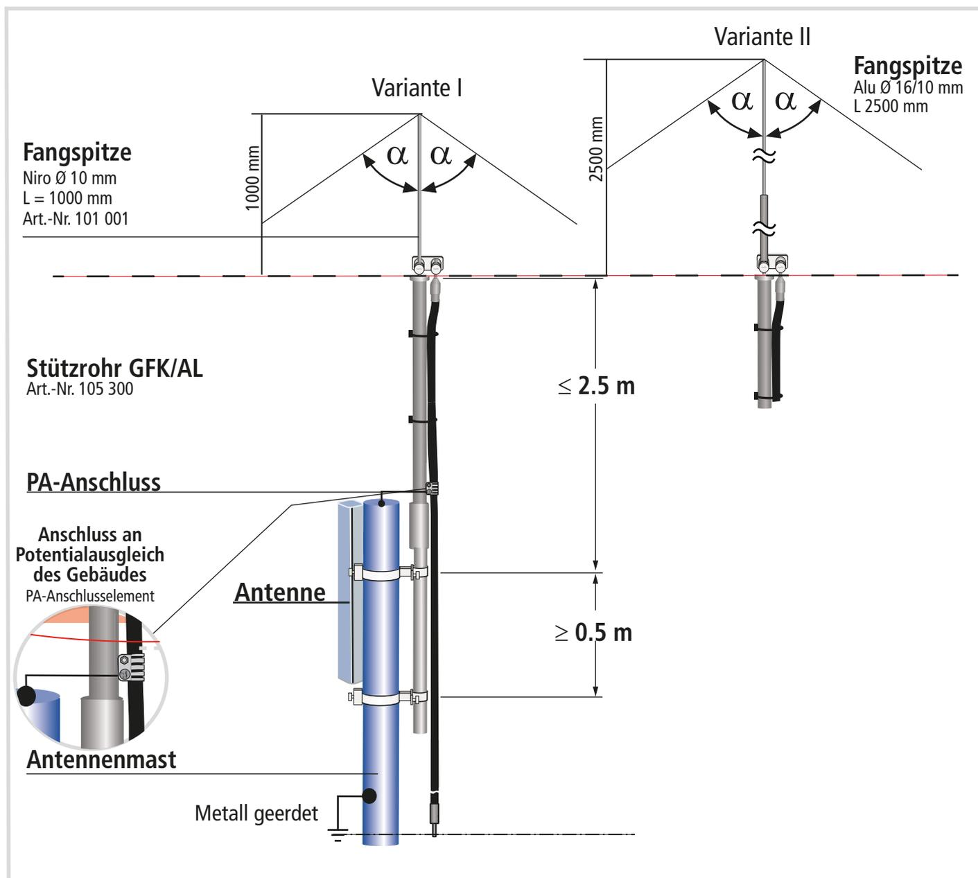
**Bild 12** Befestigungsstützrohr bis max. Windgeschwindigkeit 185 km/h (Variante I)
