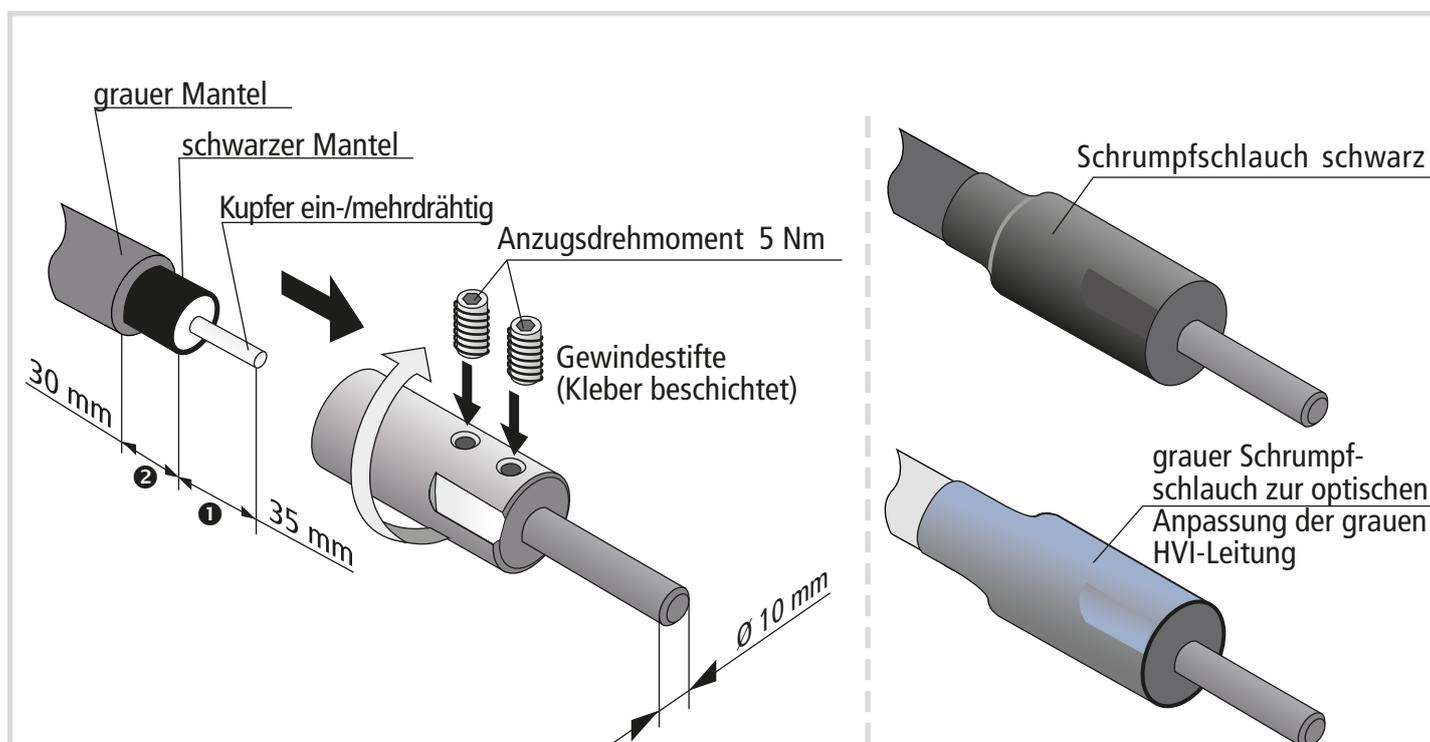
**Bild 5** Montage des Erdanschlusselementes / Anschlusselementes
