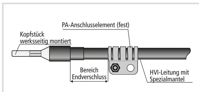
**Bild 4c** HVI®Leitung I, II und III vorkonfektioniert
