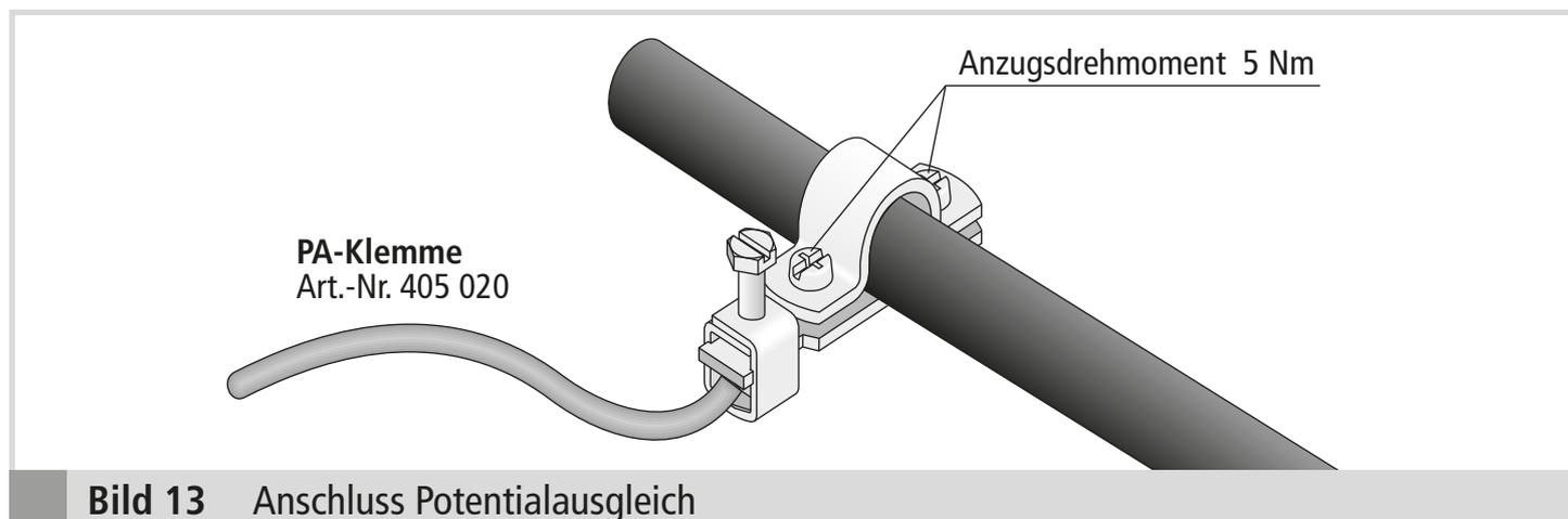
**Bild 13** Anschluss Potentialausgleich
