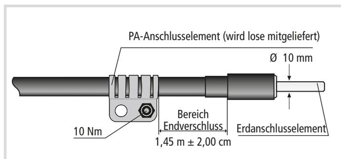
**Bild 4d** HVI®Leitung II und III vorkonfektioniert bzw. HVI®long-Leitung II und III
