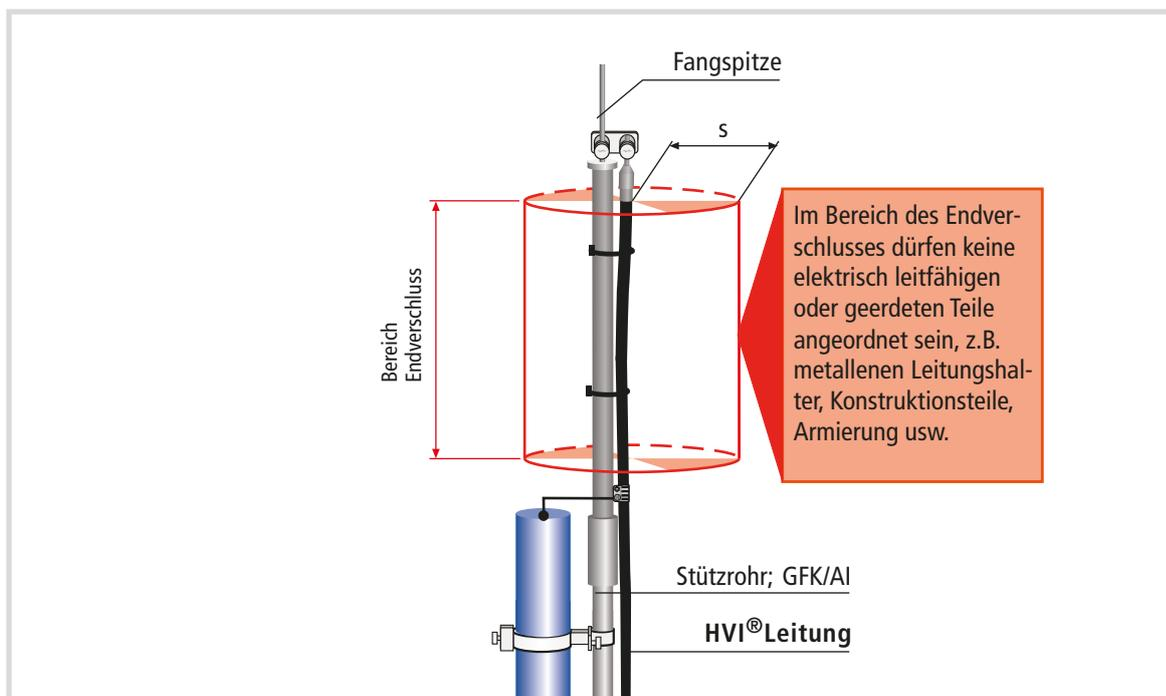
**Bild 4a** Endverschluss am Stützrohr
