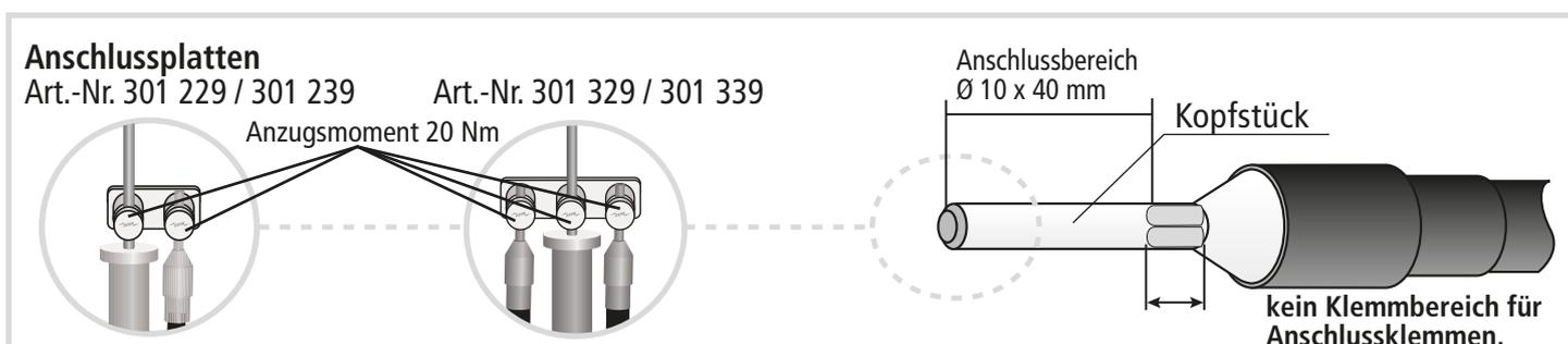
**Bild 8** Anschlussmöglichkeiten / Kopfstück (Details aus Bilder 3 und 14)
