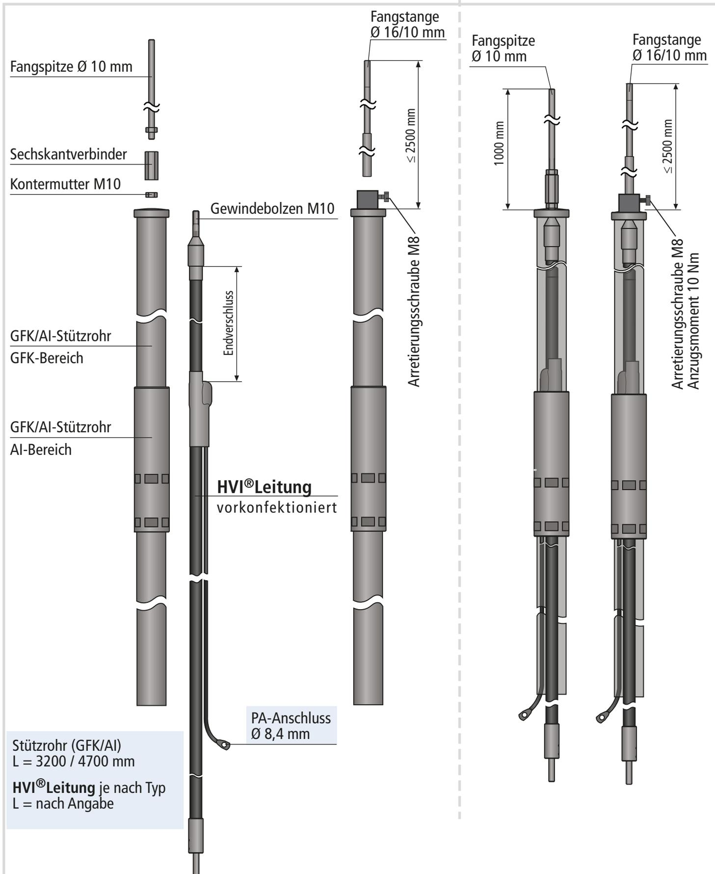
**Bild 9 HVI®Leitung vorkonfektioniert - Innenliegende Verlegung im Stützrohr**
