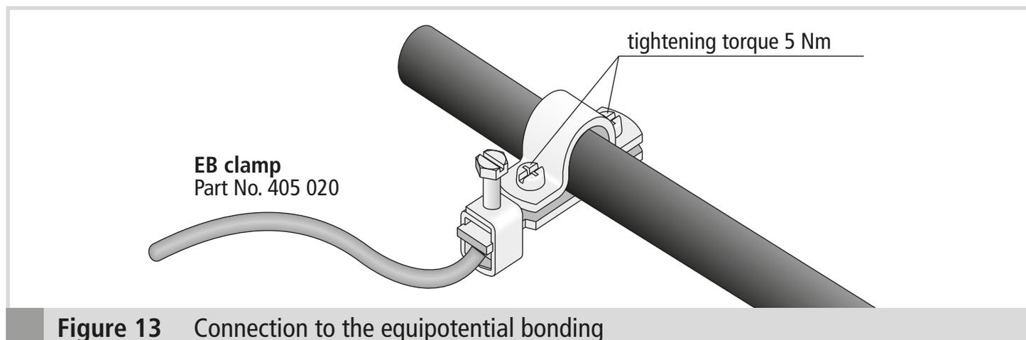
**Figure 13** Connection to the equipotential bonding
