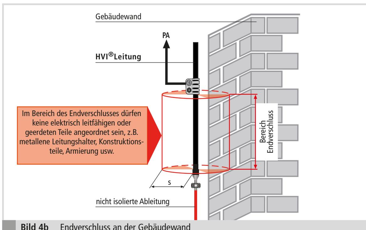
**Bild 4b** Endverschluss an der Gebäudewand
