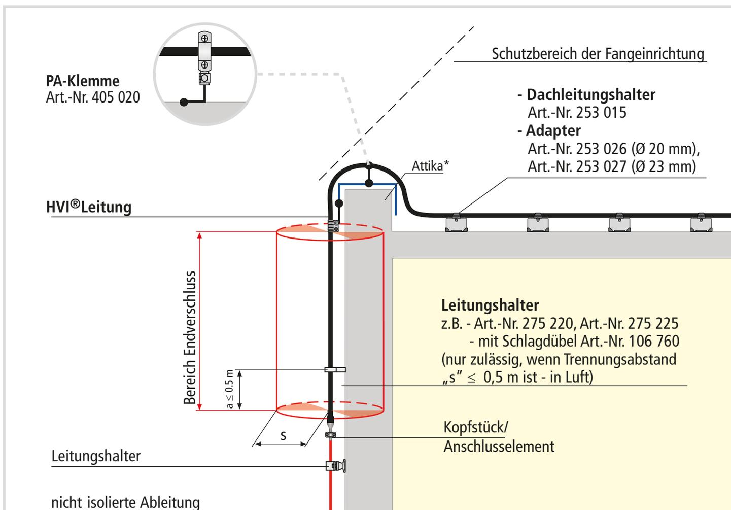
**Bild 7** Übergang HVI®Leitung auf nicht isolierte Ableitung;
