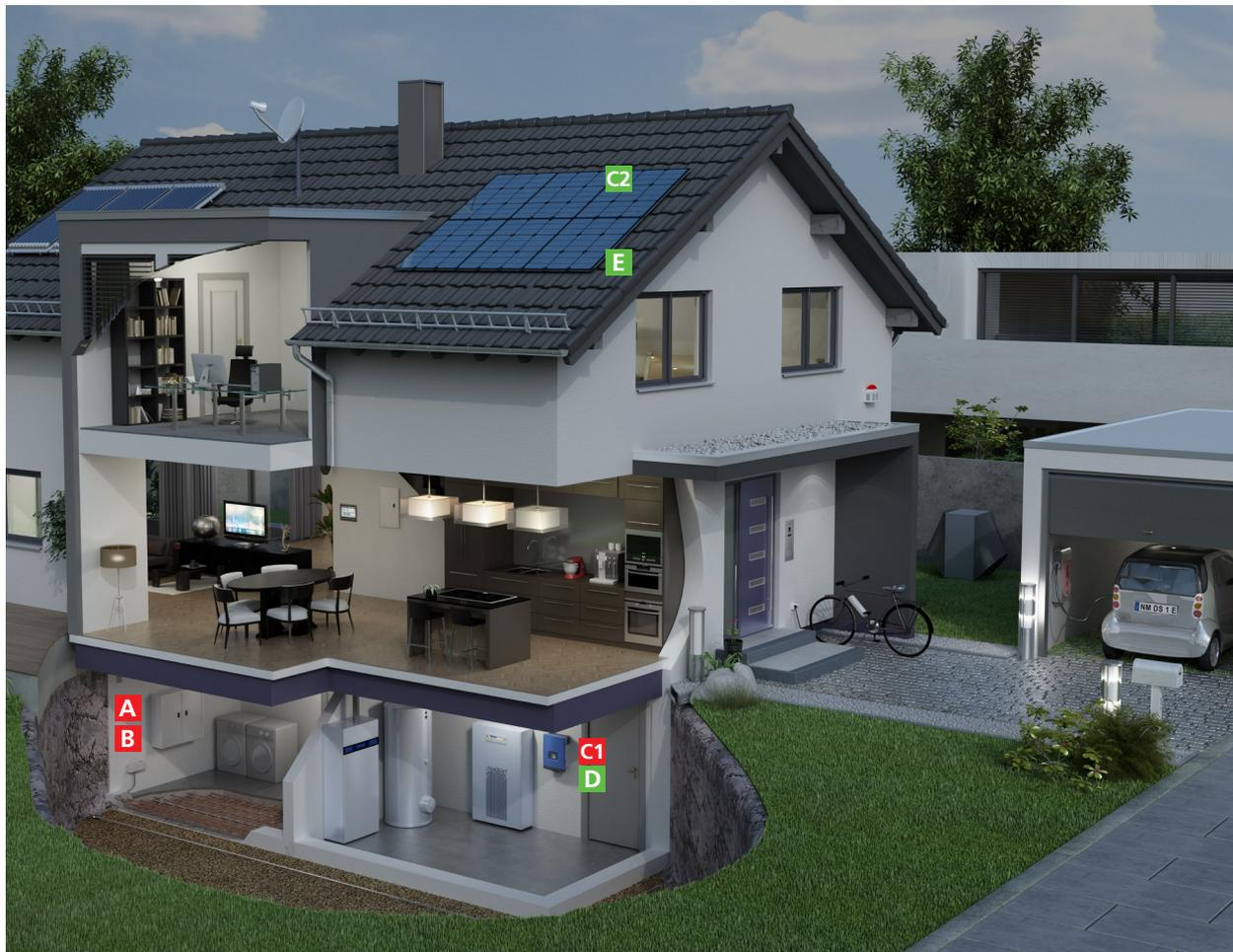
Les parafoudres doivent être installés même en l'absence de paratonnerre (système de protection externe contre la foudre).
