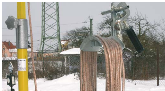
Erdungsspieß mit aufgewickelter Erdungsleitung.
