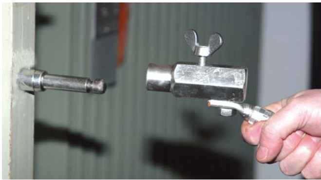
Erdungsfestpunkt mit Ringnut und Erdanschlussbuchse.
