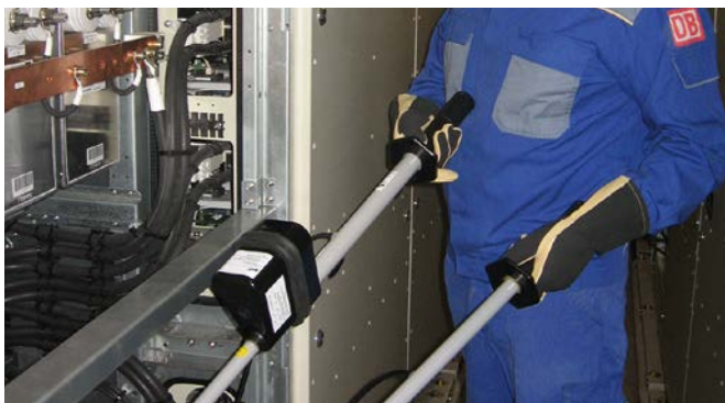
Gleichspannungsprüfer PHE/G II für Gleichstromzwischenkreise (ICE-Triebkopf).
