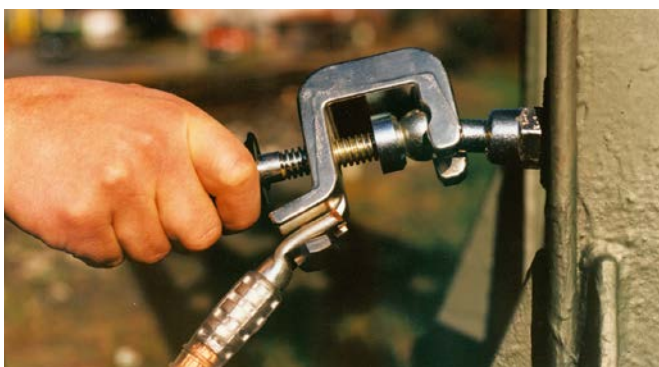
Universalerdungsklemme mit Handgriff auf einem Kugelfestpunkt.
