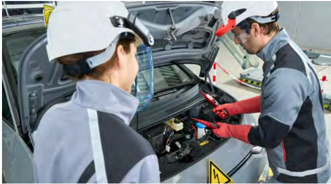
Prüfung der hohen DC-Spannung eines HV-Elektrofahrzeuges.
