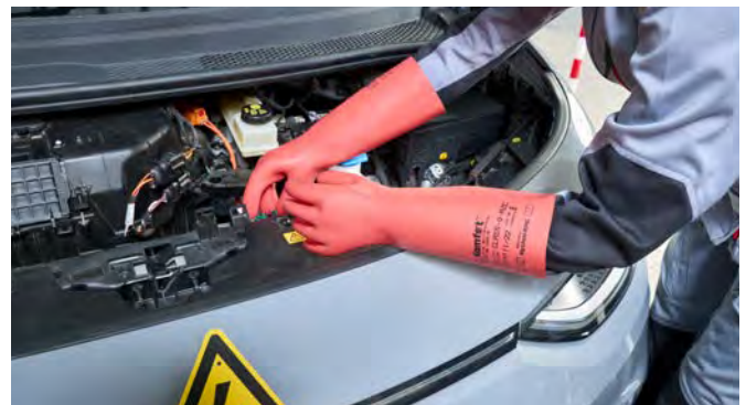
Arbeiten an einem E-Fahrzeug mit isolierenden Handschuhen.
