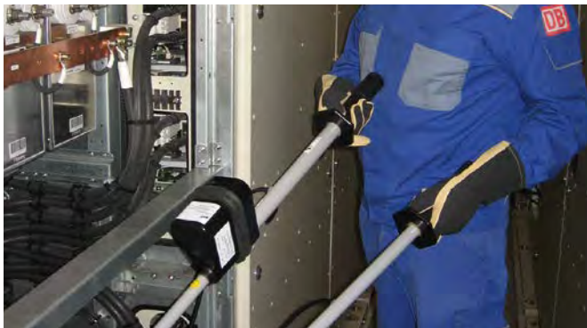
Gleichspannungsprüfer PHE/G II für Gleichstromzwischenkreise (ICE-Triebkopf).
