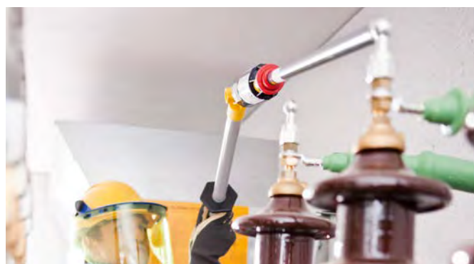
Prüfkopf PHE III mit Universalzahnkupplung und Isolierstange.
