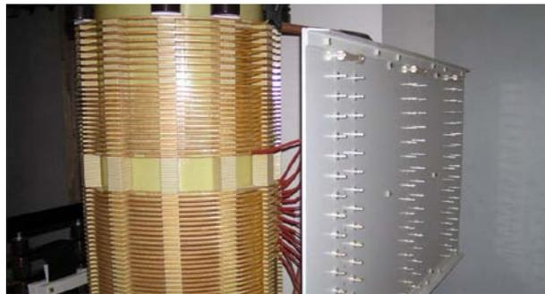
Montage der Module der Konstantstromregelung der Diodenkette im Schienensystem
