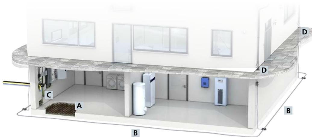
**Die Erdungsanlage ist die Voraussetzung für den sicheren Betrieb der elektrischen Systeme im Gebäude.** Fundament- oder Ringerder stellen eine sichere und kostengünstige Erdungsanlage dar – und dies über die gesamte Lebensdauer des Gebäudes. Der Fundamenteerder ist zudem normativ gefordert<sup>1)</sup>. Für ihn ist eine Dokumentation der Errichtung und Messung zu erstellen.
