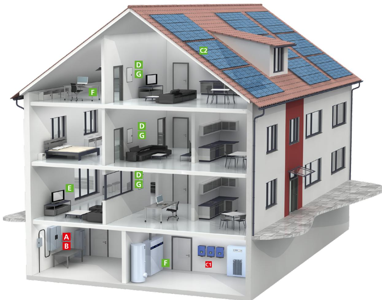
Die Besitzer einer Eigentumswohnung oder die Mieter des Wohnraums verlassen sich darauf, dass ihre Haushaltsgeräte und Infotainment-Systeme sicher betrieben werden können. Durch die neuen Installationsnormen DIN VDE 0100-443, -534 und -712 zum Überspannungsschutz entsteht auch für den Vermieter oder die Eigentümergemeinschaft eine Sorgfaltspflicht<sup>1)</sup>. Was für Neubauten obligatorisch ist empfiehlt sich auch für bestehende Gebäude.
