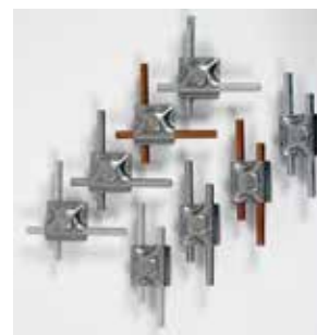
Fig. 10 : combinaisons de test pour borne MV (disposition parallèle et en croix)
