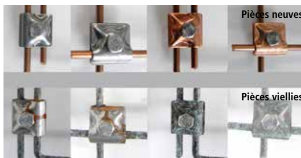
Fig. 9 : composants à l'état neuf et après le vieillissement artificiel
