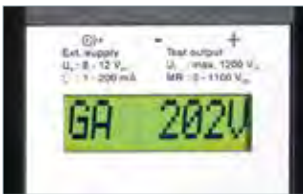
Indication de la tension d'amorçage mesurée.
