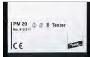
Test de l'amorçage des éclateurs à gaz, varistances et diodes Zener.
