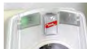
Indication optique de fonctionnement/de défaut du côté énergie (230 V).
