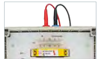
Adaptateur de test pour les parafoudres modulaires.
