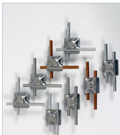
Bild 4: Prüfkombinationen für MV-Klemme (Parallel- und Kreuzanordnung).
