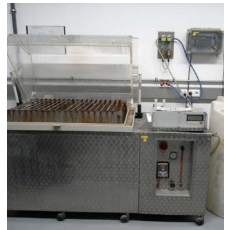
Bild 1: Prüfungen mit einer Salzsprühtruhe.
